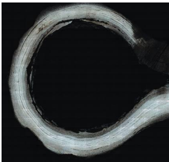
25. ábra. A fejsze nyéllyuka metszetének optikai mikroszkópos képe.
