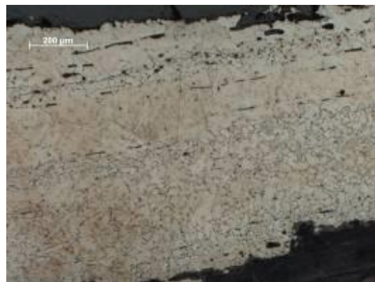
27. ábra. A fejsze élének réteges szerkezete.
