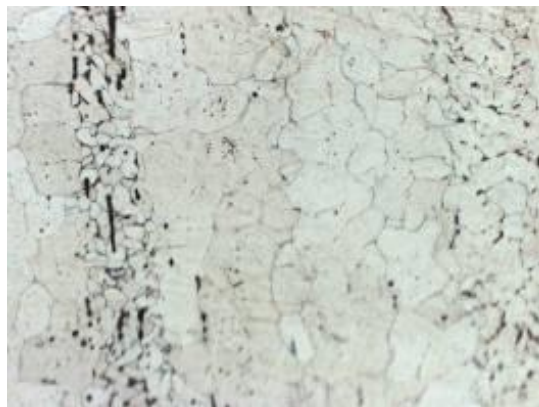
26. ábra. A fejsze réteges szerkezete optikai mikroszkópos képen.
