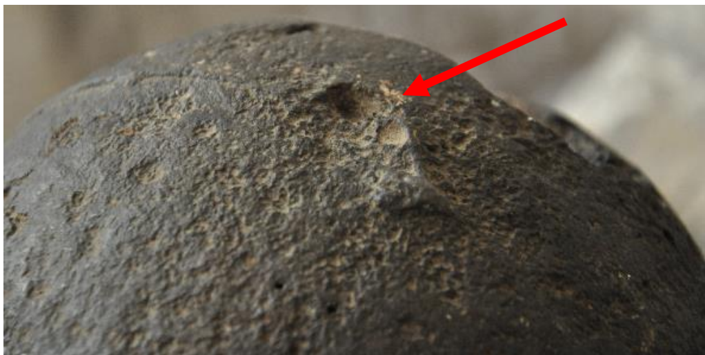
8. ábra. Tömörre öntött ágyúgolyó az oldalán körbefutó öntési varrattal és a letört öntőcsapnak a gömbfelületéből kiemelkedő maradványaival.
